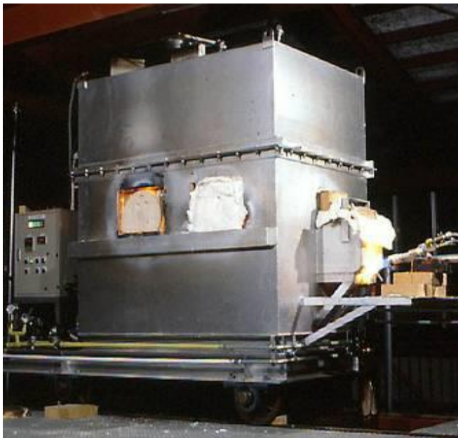
図 7. 自ら設計した「Glass No.4」シリーズの溶解炉と徐冷炉 図 8. ガラス徐冷炉内
